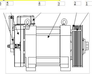
1、Ward off rope device 2、Sheave 3、PMS motor 4、Connection box 5、Brake system 6、Encoder
