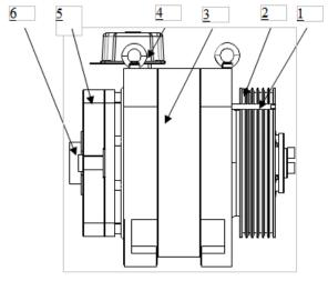
1、Ward off rope device 2、Sheave 3、PMS motor 4、Connection box 5、Brake system 6、Encoder
