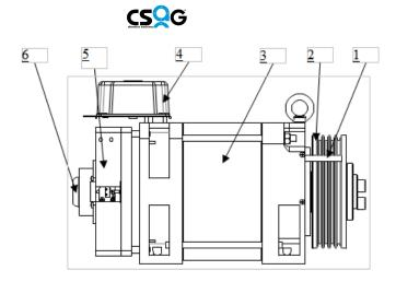
1、Ward off rope device 2、Sheave 3、PMS motor 4、Connection box 5、Brake system 6、Encoder
